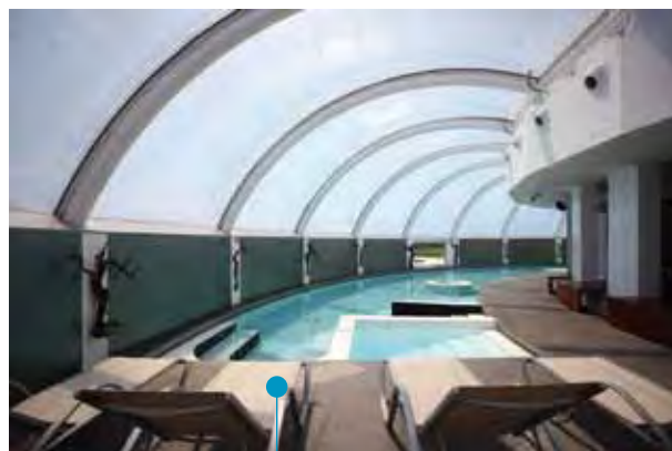
Подушки ETFE позволяют контролировать внутренний климат в новой зоне.
